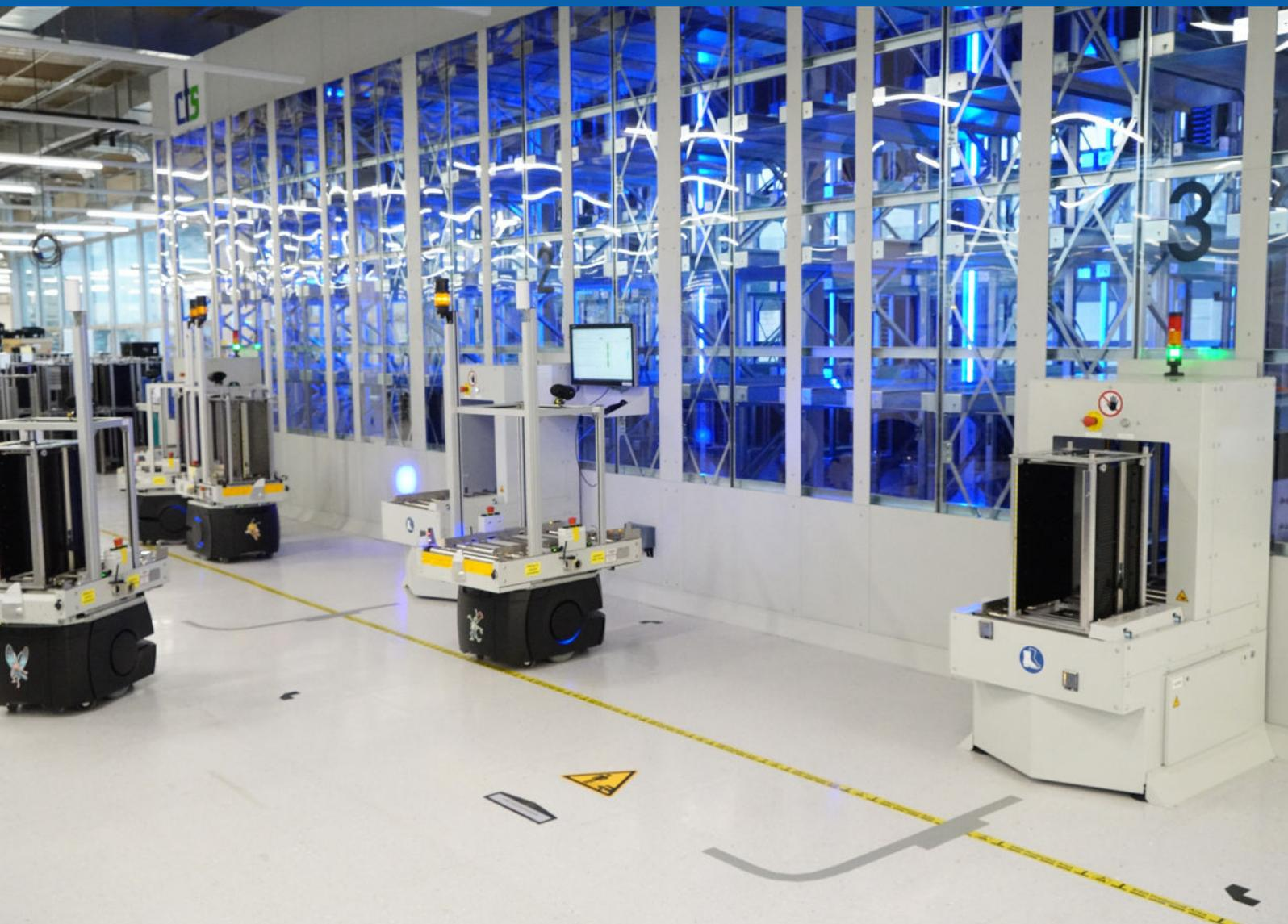
Die Anforderungen hinsichtlich Flexibilität und Produktvarianz nehmen stetig zu, anspruchsvollere Materialflüsse benötigen effiziente Lösungen! Das cts Smart Warehouse lagert die Magazine platzsparend und produktionsnah – rückverfolgbar und vollständig automatisch belieferbar mittels AMR. Damit sparen Sie Ihre wertvolle Fläche und optimieren Ihren Materialfluss.
