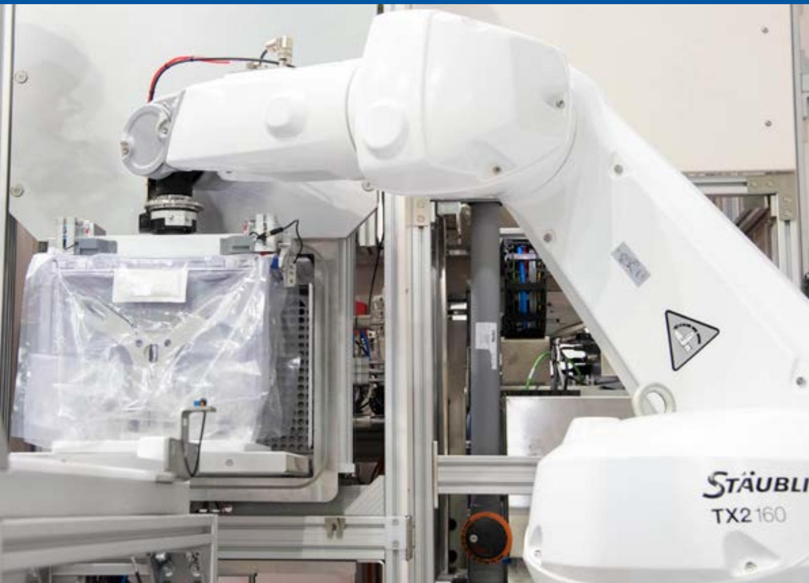
Die Verpackung der Roh-Wafer für den Transport in ein Halbleiterwerk (FAB) ist ein aufwändiger Prozess und unterliegt strengsten Kriterien. Wir haben den Verpackungsvorgang voll automatisiert! Unser AutoBagging-Tool (ABT) erhöht deutlich den Durchsatz und bietet eine beträchtliche Qualitätssteigerung und Sicherheit beim Verpacken. Der Durchsatz liegt bei 3.000 bis 8.000 FOSB/Monat (75k bis 200k Wafer/Monat).
