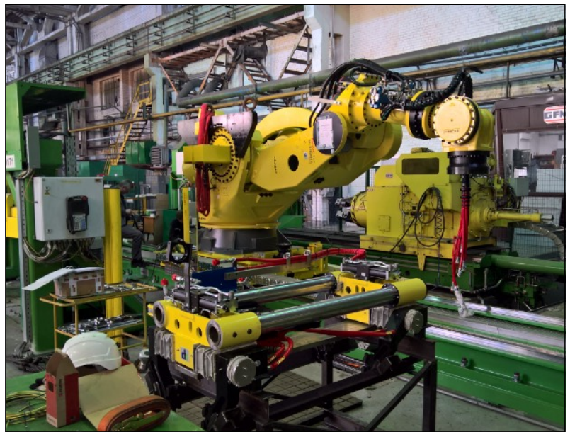
Bild 1 & 2: Mehr als acht Tonnen wiegt der neu installierte Fanuc-Roboter. Er ist in der Lage, die schweren Turbinenschaufeln zu handhaben.
