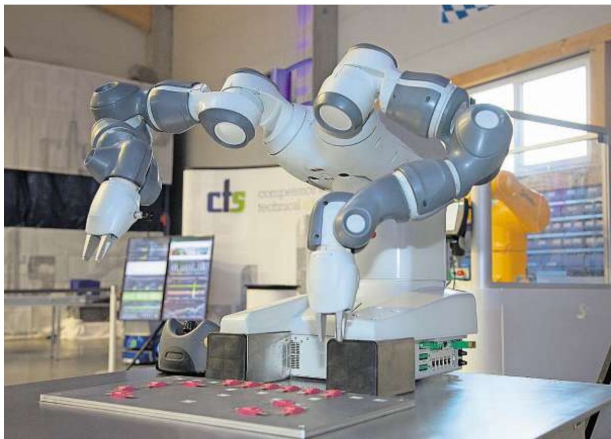
Bei der Integration von Robotern in die Fertigung hat CTS immer wieder Meilensteine gesetzt: Hier im Bild zu sehen ist der Zweiarmroboter Yumi, der dank seiner Feinfühligkeit ohne Einhausung Seite an Seite mit seinen menschlichen Kollegen arbeiten kann. Fotos: CTS
