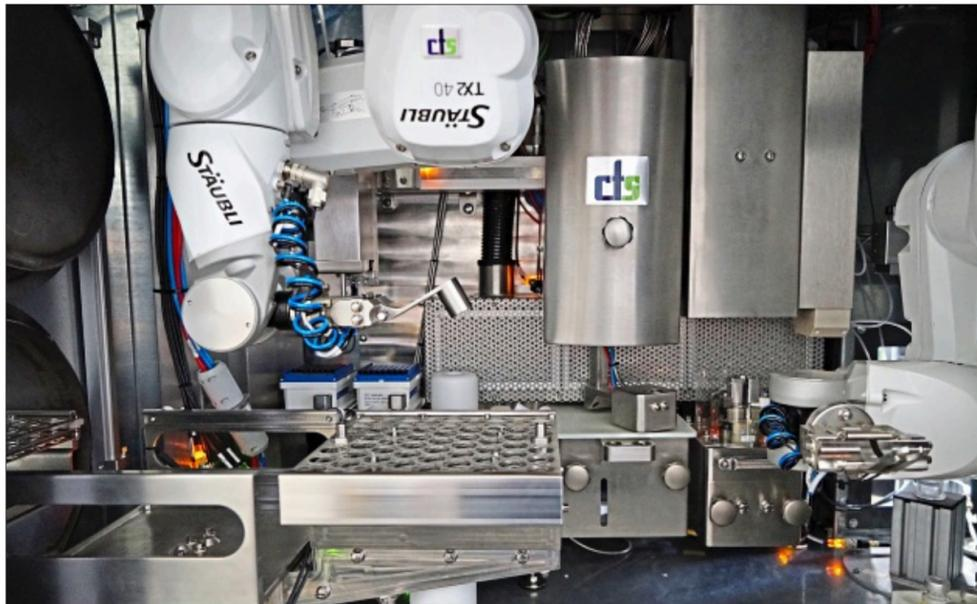
**Strahlensicher:** Hier wird der radioaktive Stoff, der bei der Krebsbehandlung hilft, abgefüllt. Das Bleigehäuse wiegt rund 750 Kilo. – Fotos: cts; dpa
