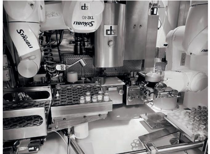
Roboterbasierte Abfüllungs-Unit einer Produktionslinie für radioaktive Krebsmedikation
