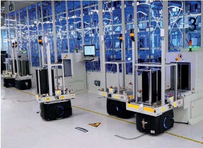
Smart Warehouse für das Leiterplattenmagazin einer Elektronikfertigung – vollständig autonom bedient durch mobile Roboter (AMRs)
